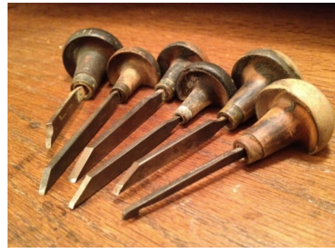
6 pav. Metalo raižymo įrankiai, naudoti metalinių giliosios spaudos formų gamybai.
