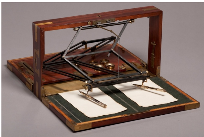
1 pav. Kopijavimo įrenginiai, leidę vienu metu rašyti dokumentą ir kurti jo identišką kopiją. Nuotraukoje JAV prezidento Tomo Džefersono sukurtas poligrafas.
