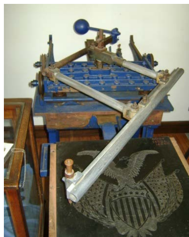
2 pav. Poligrafai pasitarnavo kuriant pantografus. Pantografai – tai prietaisai, kurių pagalba buvo keičiamas analoginių žemėlapių mastelis.
