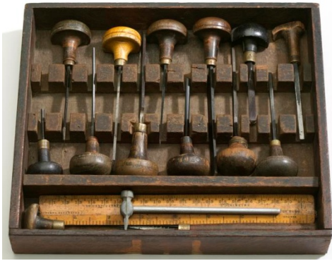
5 pav. Medžio raižymo įrankiai, naudoti medinių iškiliosios spaudos formų gamybai.
