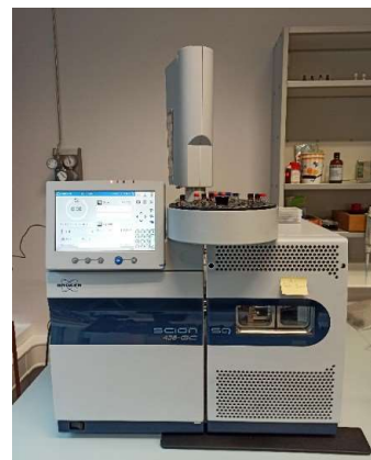
Dujų chromatografas – Masių spektrometras (Bruker Scion SQ 436-GC)
